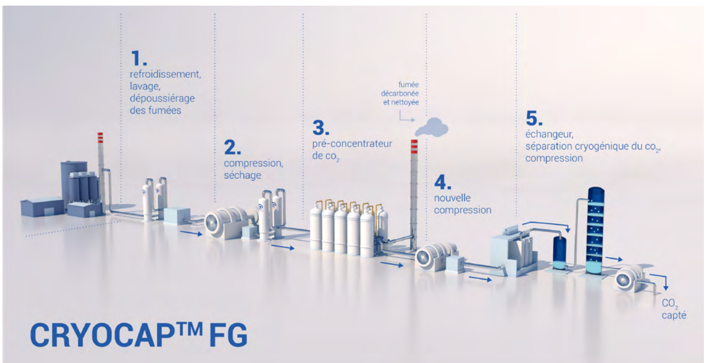
Figure 35 – Schéma de principe simplifié de l'unité Cryocap™ FG (non représentatif des plans et dispositions des équipements)
