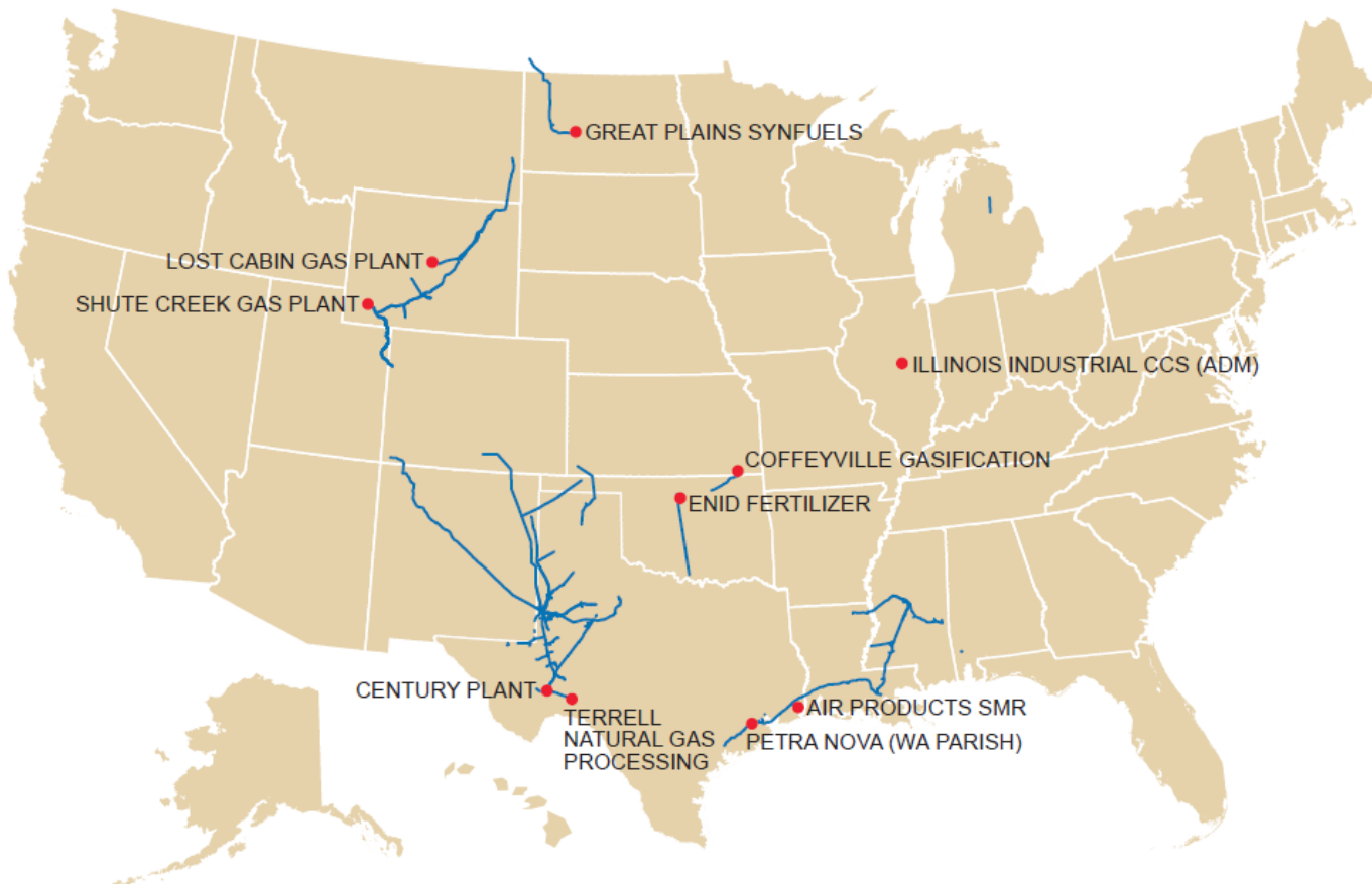
Figure 58 - Canalisations de transport de CO 2 en fonctionnement aux États-Unis
